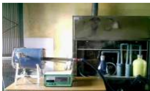
Hình 1. Lò thiêu oxihóa và hệ thống thu bụi
